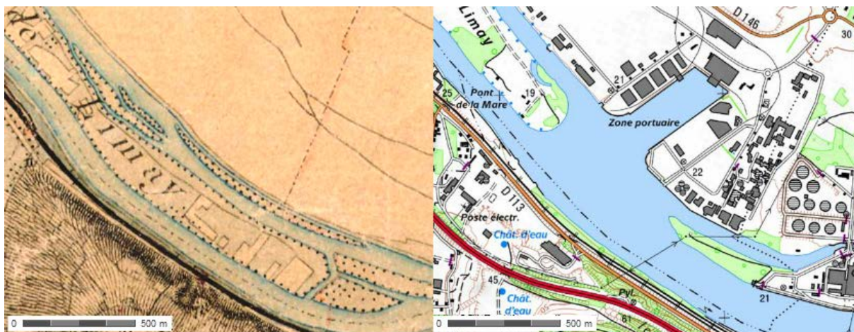
Figure 5 : Des îles ont été partiellement ou totalement supprimées lors du creusement du bassin de la centrale électrique de Porcheville (78). Comparaison entre la carte d'État-major et la carte IGN au 1/25 000. (Source : Géoportail)
