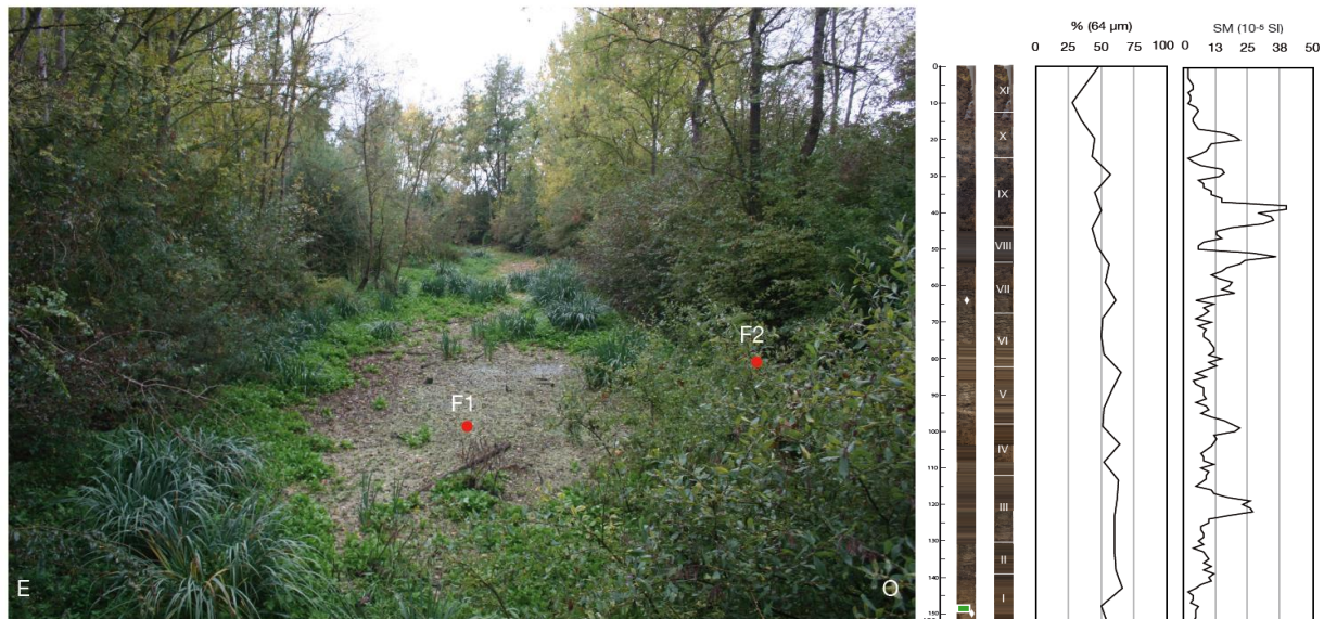
Figure 4. Emplacement des sondages carottés F1 et F2 au niveau de la coupe DD' et premières descriptions (granulométrie de la fraction fine et susceptibilité magnétique) (M2 Charrondière-Lewis, 2019).
