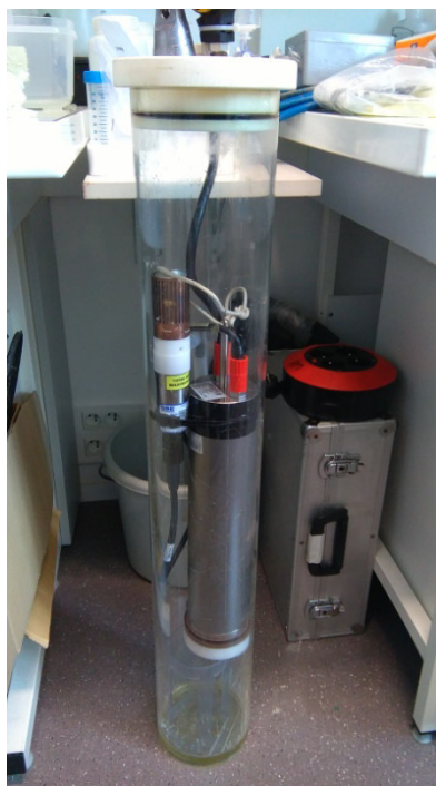
Figure 2 : Capteur Contros HydroC-CO 2 pour la mesure in situ de la concentration en CO 2 dissous, dans le dispositif d'étalonnage au laboratoire.
