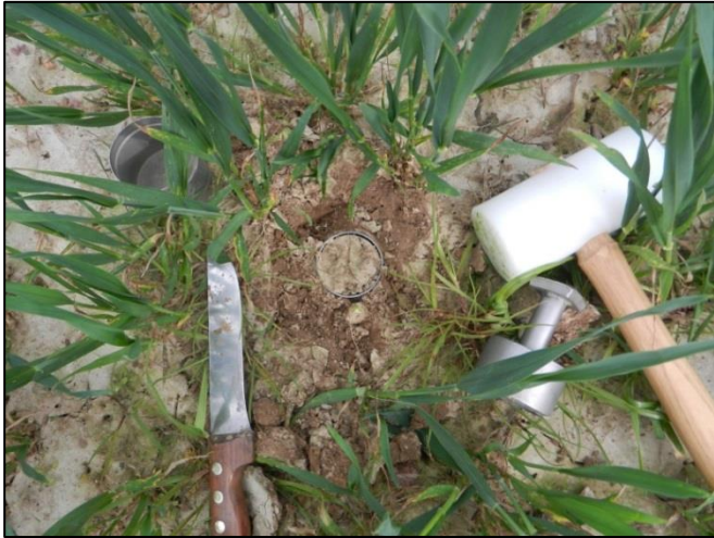
Densité apparente (cylindre et sonde Gamma)
