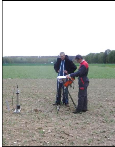
Densité apparente (cylindre et sonde Gamma)
