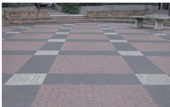
Figure 12 : Influence de la couleur sur l'emmagasinement de chaleur (composition de revêtement de sol à la ZAC de la Grange-aux-Belles, 1er août 2011 vers 22h) (APUR, 1, 2014 [17])
