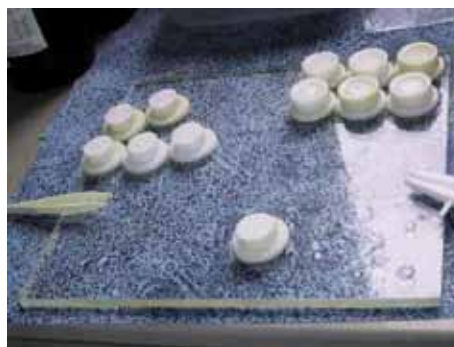
Figure 9 : Dispositifs DGT permettant d'échantillonner les métaux dissous labiles : préparation au laboratoire et immersion dans le milieu aquatique, ici une station d'épuration des eaux usées.
